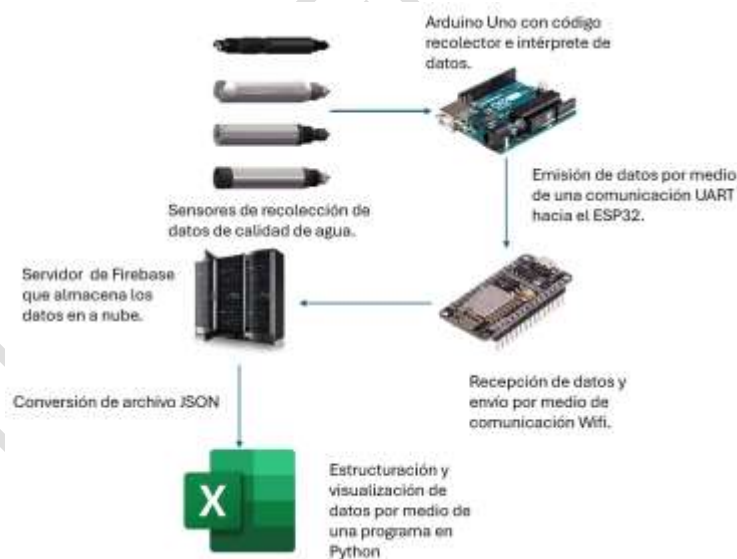
Figura 4. Diagrama de arquitectura del sistema. Fuente: Elaboración propia a partir de PowerPoint.
