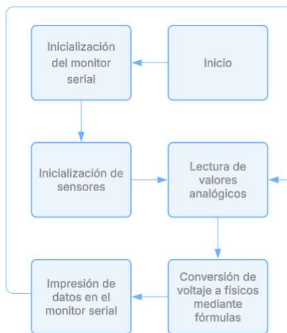
Figura 15. Diagrama de flujo del código del microcontrolador Atmega328P. Fuente: Elaboración propia a partir de Lucidchart.
